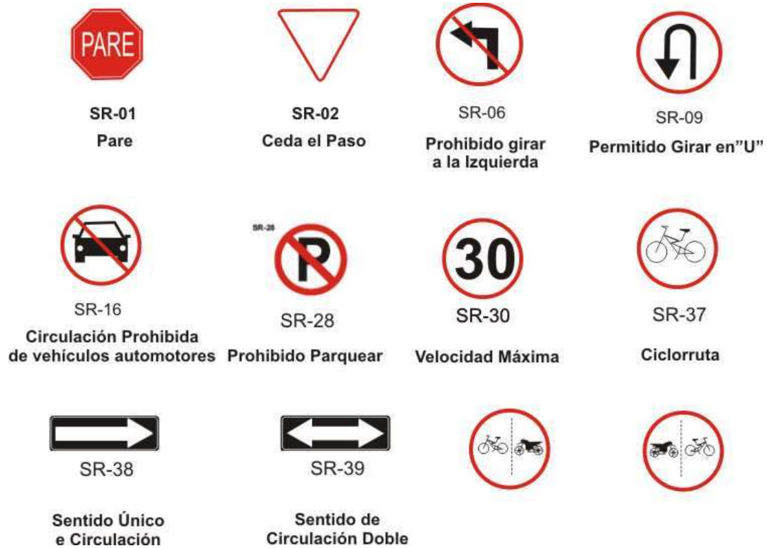
Figura 11.10. Señales Reglamentarias a ser Empleadas en el en el Proyecto de la Motovía. Diámetro = 0,75m
