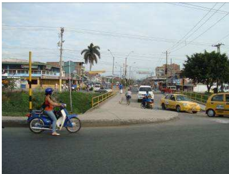
Figura 10.10. Intersección carrera 27. Aunque el puente solo funciona en el sentido Este – Sur, se observa que los motocicletas y las bicicletas lo usan en contravía, generando riesgo de accidentes. De igual manera se observa que aunque el puente está alineado con la calzada Oeste – Este de la Carrera 27, funciona es para la calzada Este – Oeste, lo cual genera maniobras inadecuadas.
