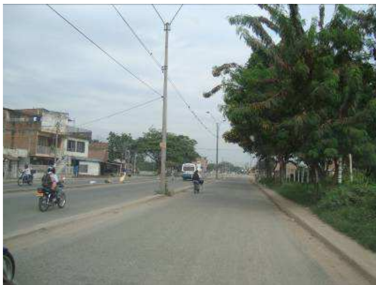
Figura 10.15. Intersección calle 73 con carrera 28D. Se aprecia la sección transversal de la Carrera 28D No existe demarcación, los andenes están invadidos por la vegetación.
