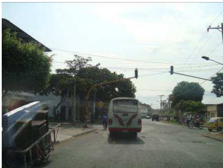
Figura 10.39 Intersección transversal 25 con calle 32. Se observa la calzada de la Transversal 25 al llegar a la intersección, la cual posee dos ménsulas de semáforos. La demarcación de las vías y la intersección son nulas. El pavimento se encuentra en regular estado.
