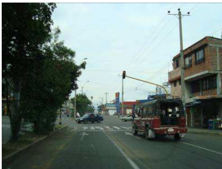
Figura 10.36. Intersección carrera 10 con calle 21. Se observa una de las calzadas de la Carrera 10, al llegar a la intersección, la cual posee la demarcación del cruce peatonal, de las líneas de carril y flechas direccionales. En el separador se observa un árbol que afecta la visibilidad del semáforo y de la intersección misma.
