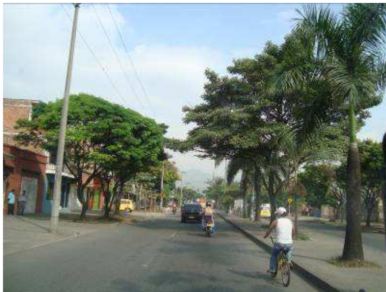
Figura 9.29. Corredor Transversal 29. Se observan las dos calzadas con dos carriles, con un separador central de 3,0m aproximadamente. Los andenes son amplios
