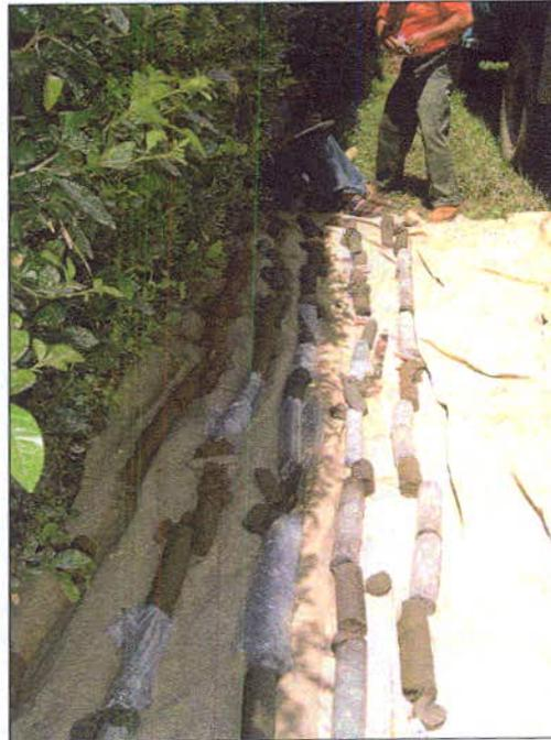
**Fotografía 3.2.** Columna estratigráfica con testigos de suelo en Vientos de Guadalupe
