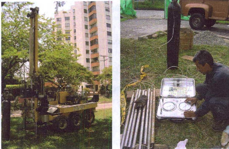
**Fotografía 3.4.** Equipo PAGANI realizando sondeo DMT en la Avenida 3N con Calle 36. A la izquierda Piezocono, a la derecha equipo de dilatómetro.
