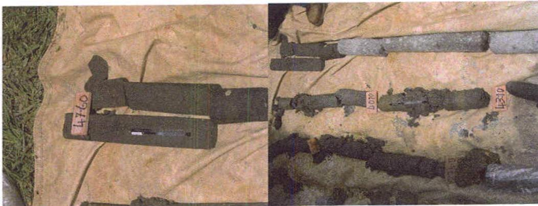
**Fotografía 5.6.** Perforación GUADALUPE, testigos de materia orgánica compuesta por madera y hojas de consistencia dura (47.6 m), arena limosa gris verdosa medianamente compacta (43.1 m) y limo orgánico gris blando (49 m).
