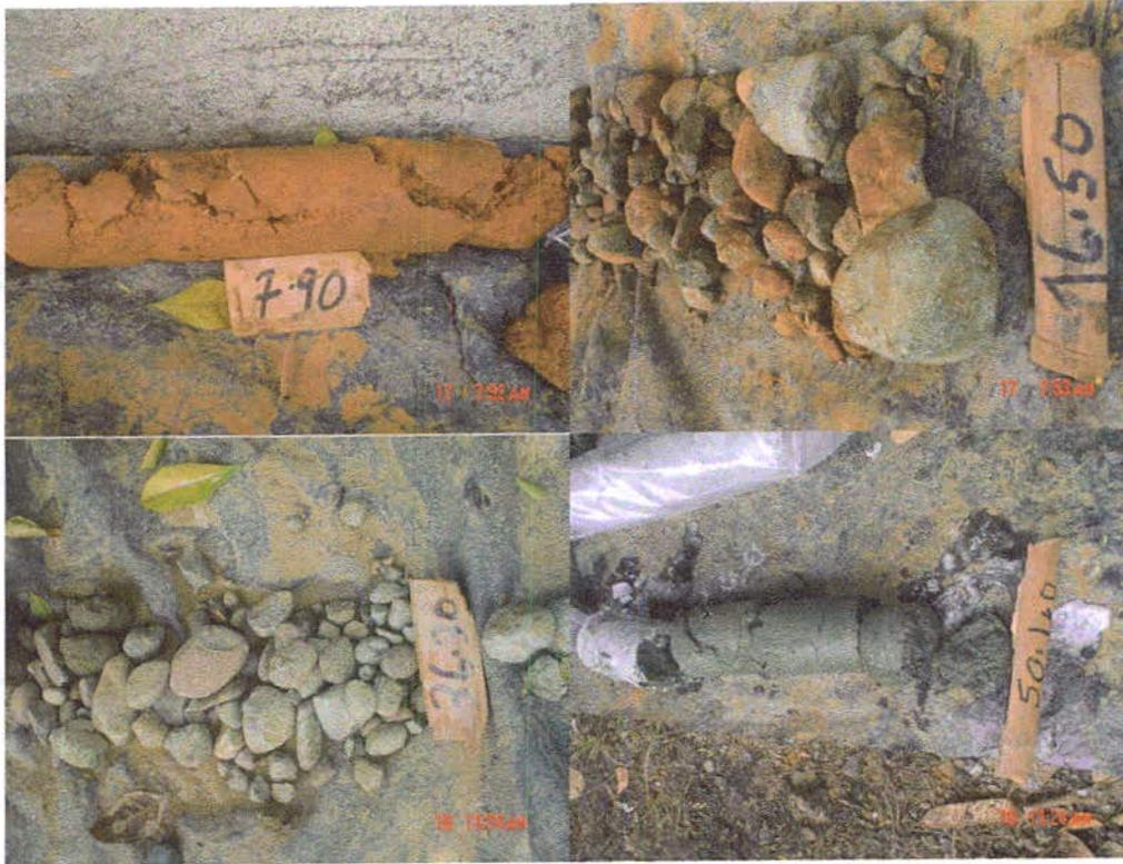
**Fotografía 5.5.** Perforación VIVERO, testigos de limo arcilloso marrón duro (7.9 m), grava gruesa verdosa y marrón subredondeada (16.5 m), grava media a gruesa verdosa subredondeada (36 m) y limo arcilloso verde oliva duro y frágil (50 m).
