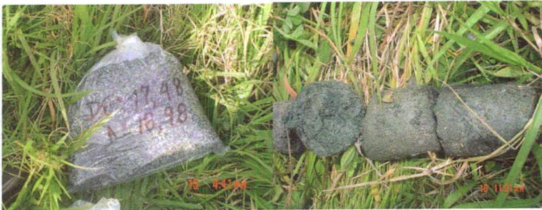
**Fotografía 5.1.** Perforación PTAR, muestra de arena media a gruesa gris (18 m) y testigo de limo arcilloso verde oliva muy duro y frágil (49 m).
