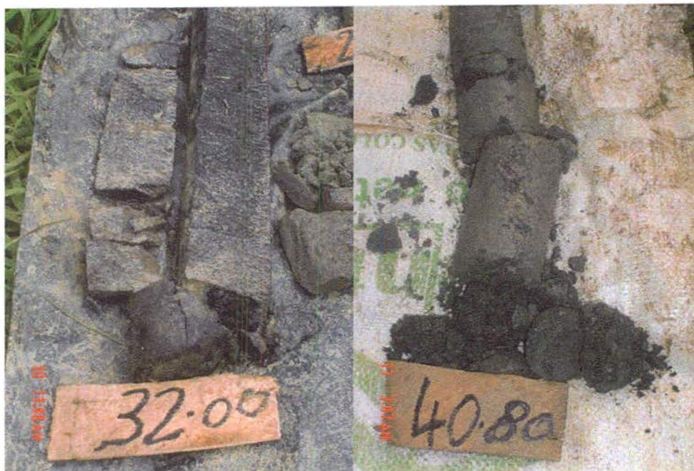
**Fotografía 5.4.** Perforación INSTITUTO TOBIAS, testigos de materia orgánica negra muy dura conformada por madera y hojas (32 m), limo verde grisáceo oscuro muy duro y deleznable (40.8 m).
