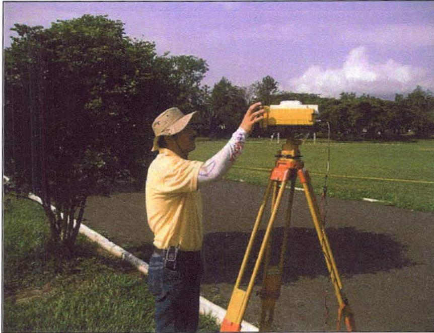
**Figura 14.** Equipo móvil GPS Trimble 4000 SE diferencial utilizado para el levantamiento topográfico en la campaña gravimétrica en la ciudad de Cali.
