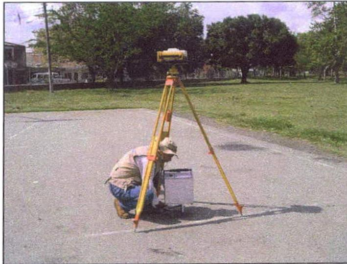
**Figura 13.** Toma de dato de campo de gravimetría (parque Caicedo, Cali) usando el gravímetro Scintrex CG-3
