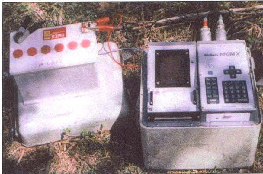
Figura 30. Equipo de refracción sísmica OYO McSeis 160MX.
