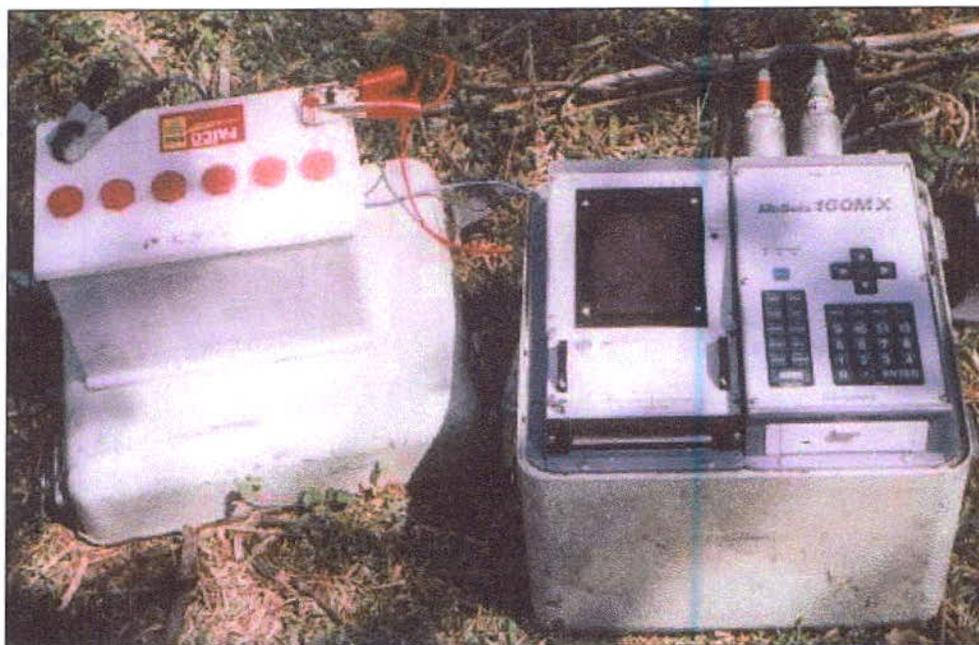
Equipo de sismica de refracción marca OYO Mc SEIS 160 MX
