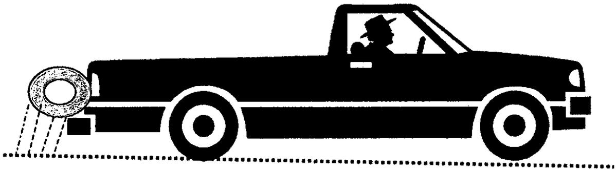
Figura No 13: Vehículo acondicionado para la irrigación de superficies polvorientas
