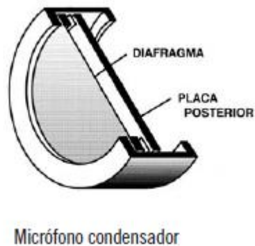
Figura 20. Elementos de un micrófono de condensador. Tomada de [35].
