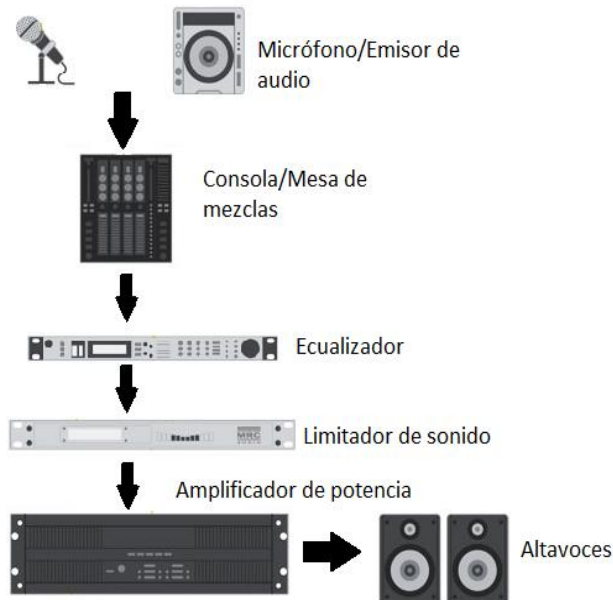
Figura 31. Configuración de una cadena electroacústica básica. Adaptada de [41].
