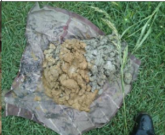
Sedimento arcilloso plástico encontrado en el fondo del piezómetro PMM – 6
